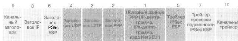
Рис. 10-15. Пакет L2TP с зашифрованными данными и дополнительными заголовками
