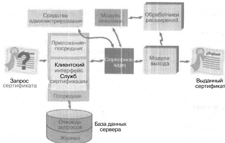
Рис. 11-3. Схема взаимодействия компонентов служб сертификации
