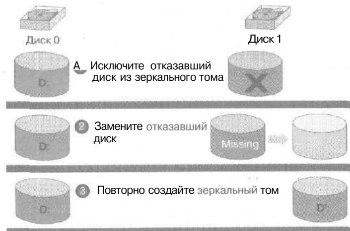
Рис. 12-14. Замена поврежденного диска из состава зеркального тома
