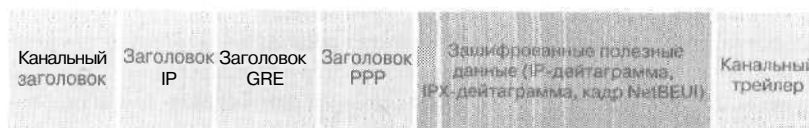
Рис. 10-14. Пакет PPTP, состоящий из зашифрованных данных, заголовка и трейлера
