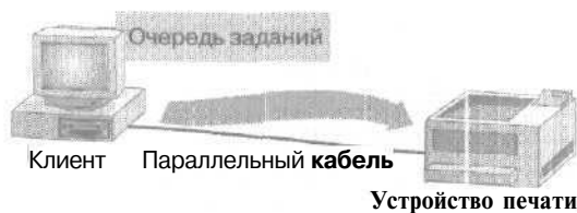
Рис. 8-2. Конфигурация с неудаленным локальным устройством печати
