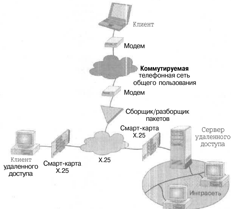
Рис. 10-7. Оборудование удаленного доступа и инфраструктура ГВС для соединений по стандарту X.25
