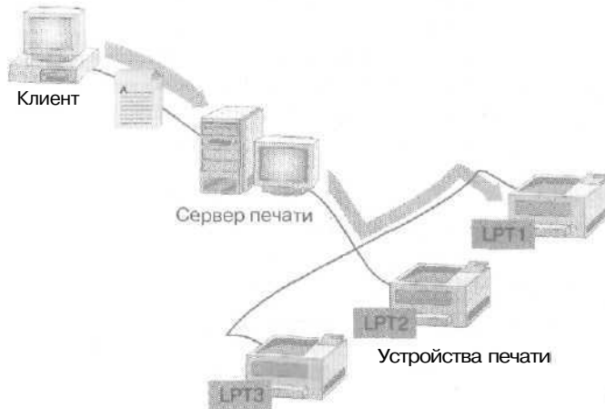
Рис. 8-12. Печать через пул, содержащий три устройства печати
