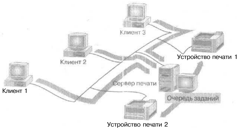
Рис. 8-5, Конфигурация с двумя удаленными сетевыми устройствами печати
