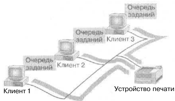
Рис. 8-3. Конфигурация с удаленным сетевым устройством печати
