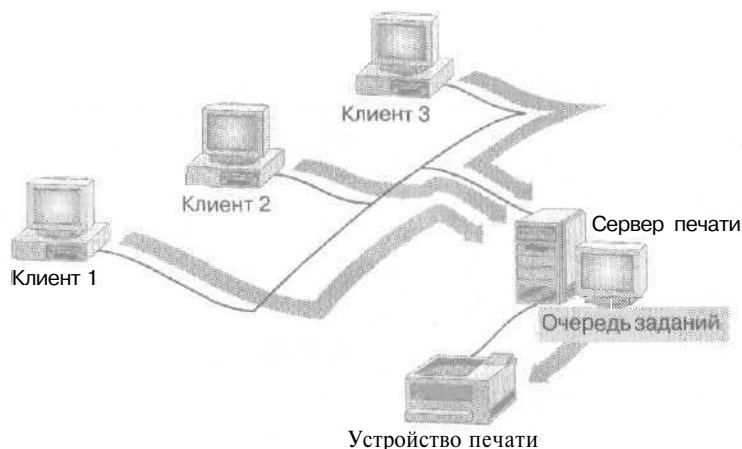
Рис. 8-4. Конфигурация с удаленным локальным устройством печати
